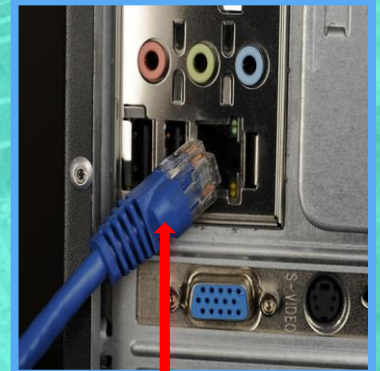
Cable de Ethernet
